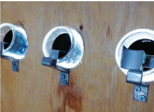
תנורים סולריים לבישול. למעלה - תנור העובד על עיקרון פשוט של ריכוז קרינה; למטה - קצוות של צינורות ואקום מבודדים הסופגים את חום השמש ובאמצעות אפקט תרמי מתחממים לטמפרטורות של כ-240 מעלות צלזיוס | באדיבות החברה לאנרגיה מתחדשת אילת-אילות
