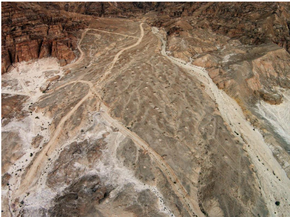
איור 15: "צלחות" – פירי כרייה ופרוספקציה סתומים (אתר "מרכבות 3" של משלחת אוניברסיטת תל אביב)
