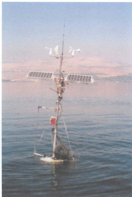
תמונה 1: מערכת LDS במרכז האגם מורכבת משרשרת תרמיסטורים תת ימיים ומתחנה מטאורולוגית.
